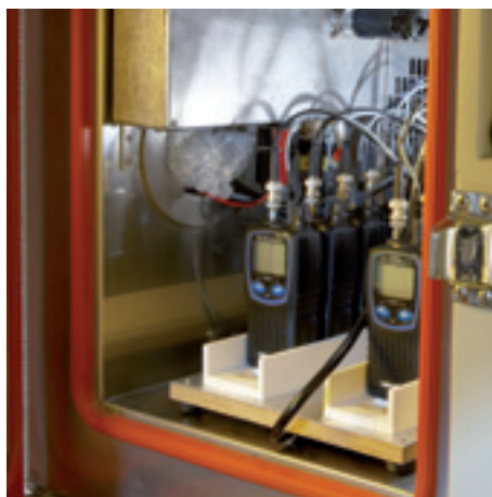
Extremtest: Efter 30 minuter i extrem kyla testas radions prestanda.
