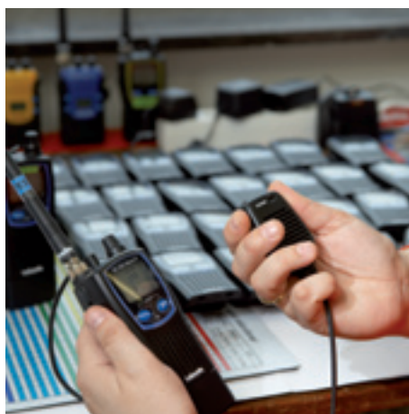
Sluttest: Vi sänder och lyssnar på radion samt provar mekaniska funktioner.
