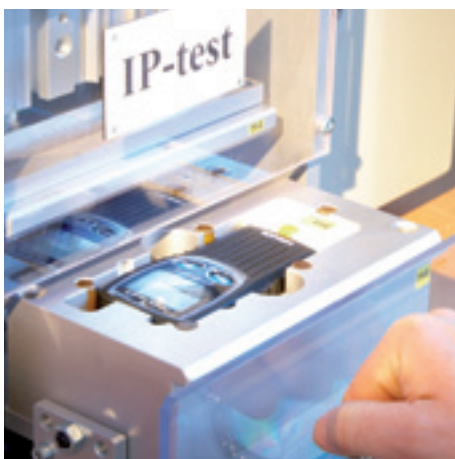
IP-test: Läcktestet säkerställer radions IP-klassning.
